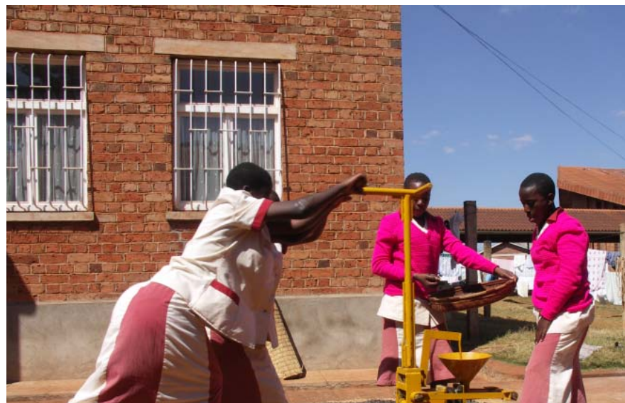
Mit einer solchen Presse wird das Öl aus den Nüssen gewonnen
